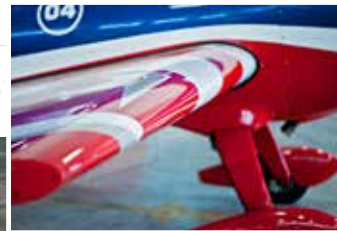
Aile carbone avec longeron carbone assurant une résistance de +10G / -10G
