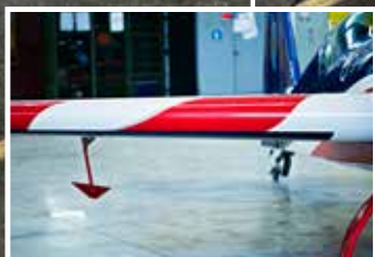
Ailerons avec corne débordante assurant un taux de roulis de plus de 420°/s
