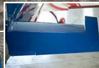
Dérive et profondeur à grand débattement donnent une grande réactivité à haute vitesse et une grande manœuvrabilité en basse vitesse.
