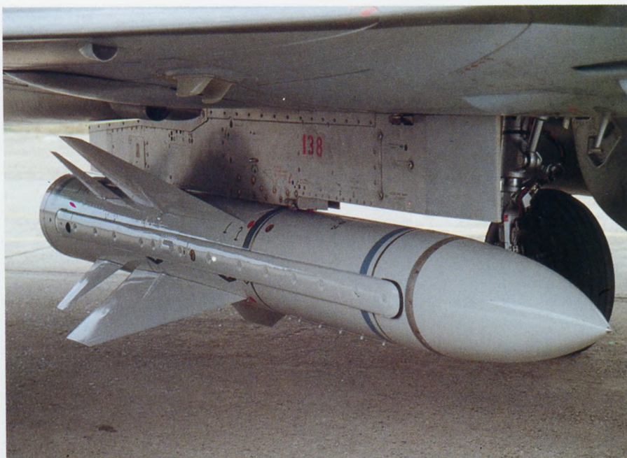
Missile air-sol anti-radar AS 37 « Martel ».
