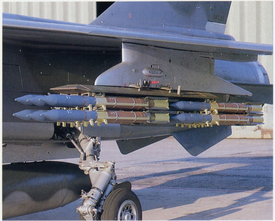
BAP 100 montés en grappe de 12 sur Mirage F1C.
