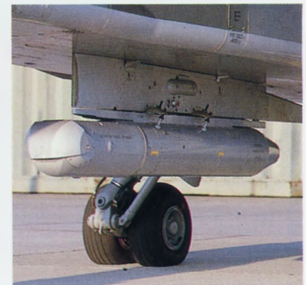
Nacelle Atlantis : automatic tracking laser illumination system).
