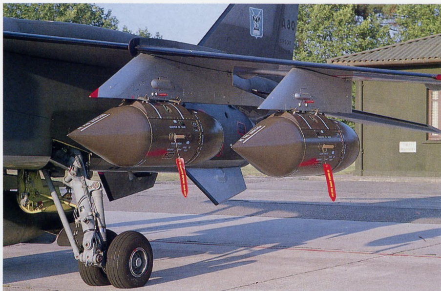
LRF1 lance roquettes type F1 (36 roquettes de 68 mm par panier).
