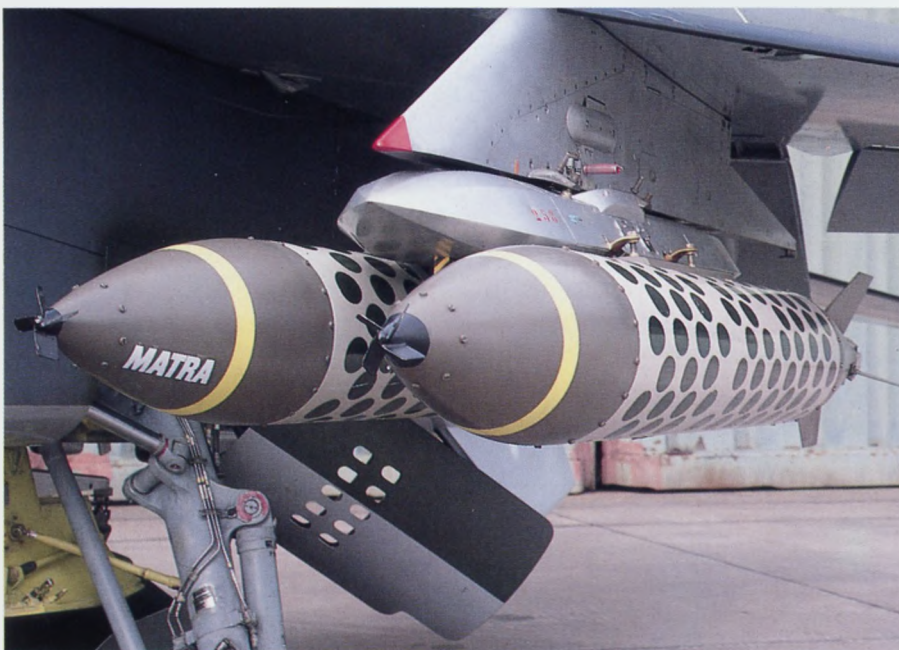
Bombe lance grenades BLG 66 « Beluga » (151 grenades de 66 mm).
