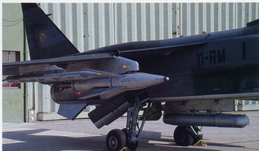
Missile air-sol AS 30 L associé à la nacelle ATLAS sur Jaguar.
