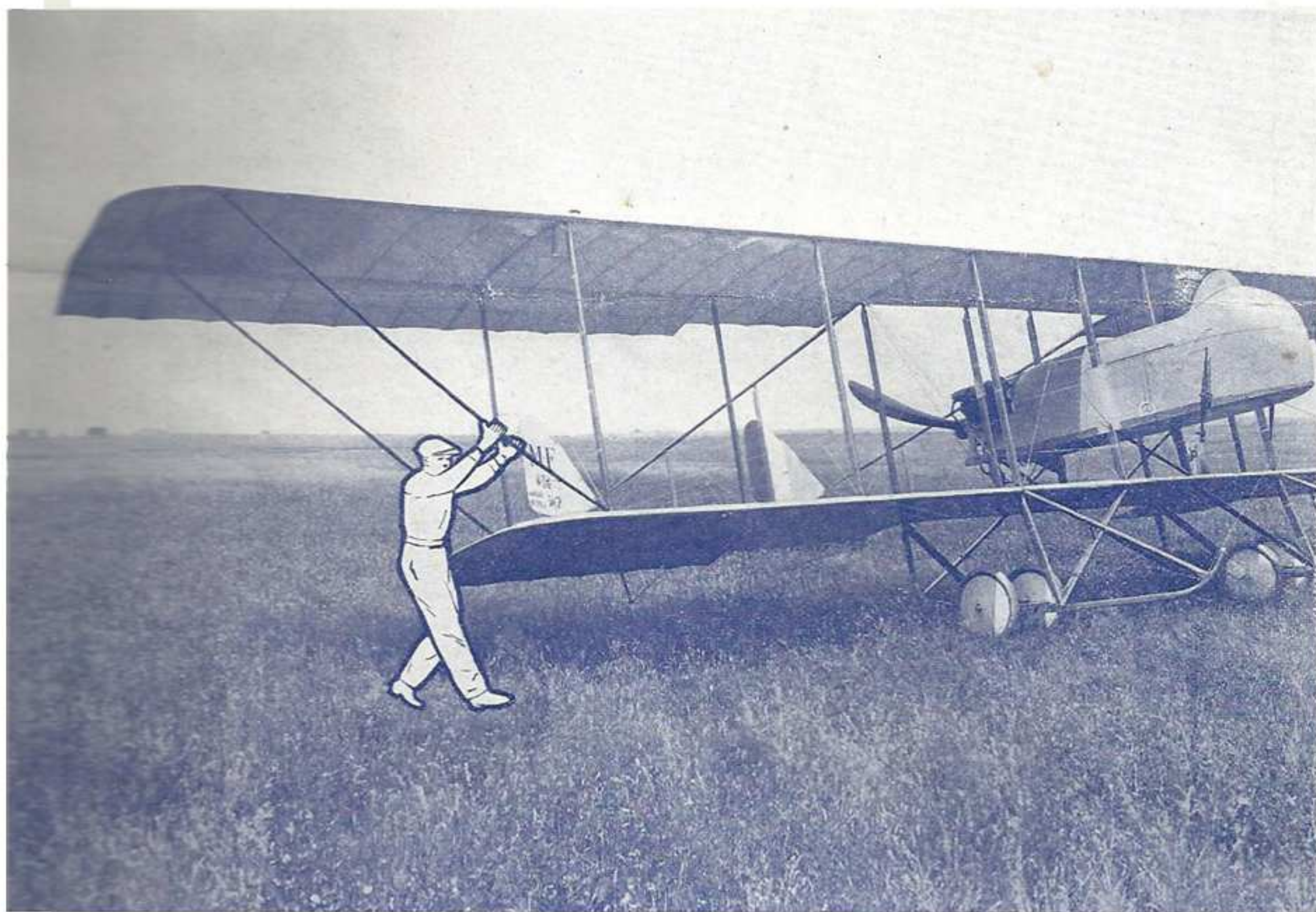
FIG. 22 — Mauvaise manière de faire tourner un avion au sol
