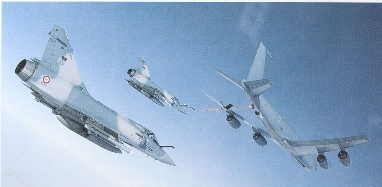
Une patrouille de Mirage 2000 C RDI de l'EC 2/5 "Ile-de-France" en phase de ravitaillement en vol sur un C 135 FR de la 93 e ERV.
