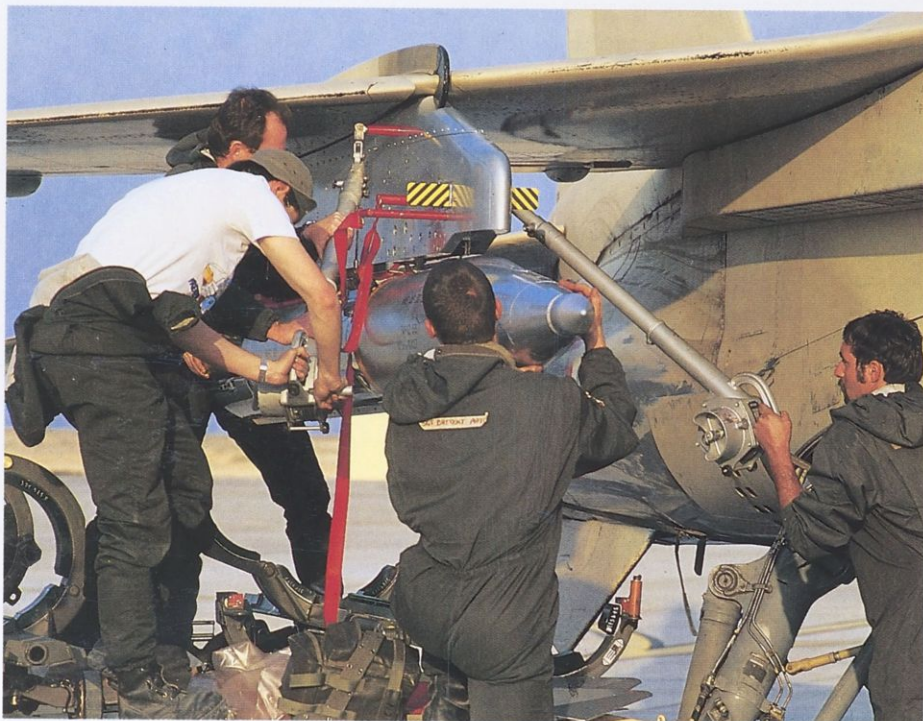
Prévu pour les objectifs durcis, le missile AS 30 Laser, tiré à près de 10 km du but, accélère sur sa cible illuminée par la nacelle laser et l'atteint avec une précision chirurgicale (pendant ce temps, l'avion tireur dégage). Cette arme s'est révélée redoutable durant la guerre du Golfe.
