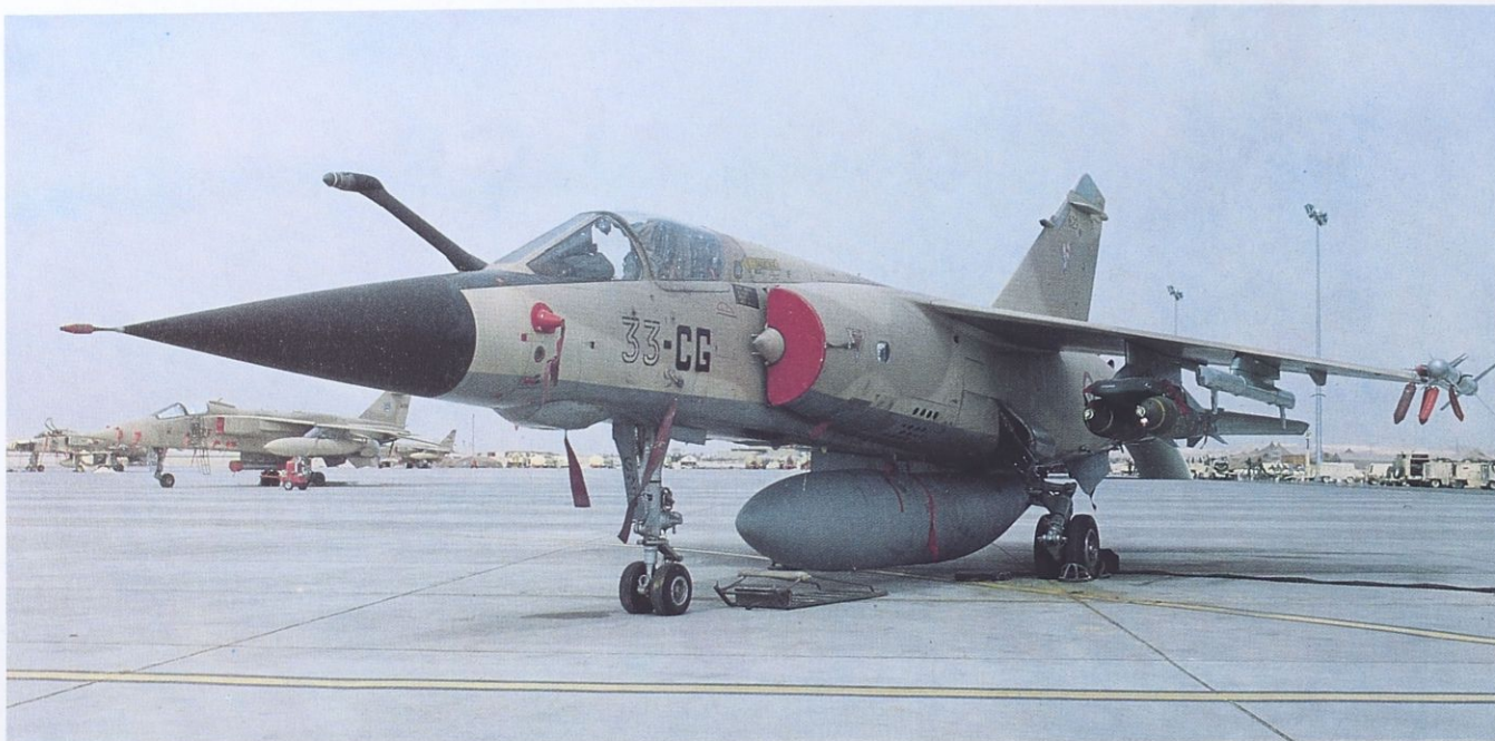
Mirage F1 CR de l'EC 1/33 "Belfort" sur la base aérienne d'Al Ahsa en Arabie Saoudite durant la guerre du Golfe. Notez sa configuration chasseur-bombardier (quatre bombes de 250 kilos), ses missiles d'autodéfense Magic II en bout d'ailes et son bidon "plaqué" de 2 200 litres.
