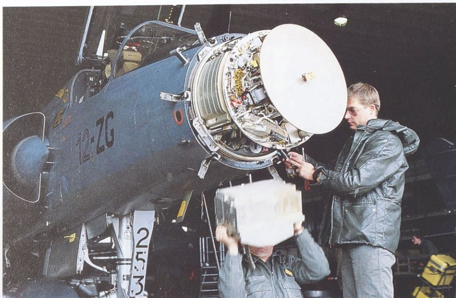
Maintenance deuxième échelon effectuée par les mécaniciens du GERMaS de la 12 e EC. Travail sur le radar Cyrano IV M du Mirage F1 C.
