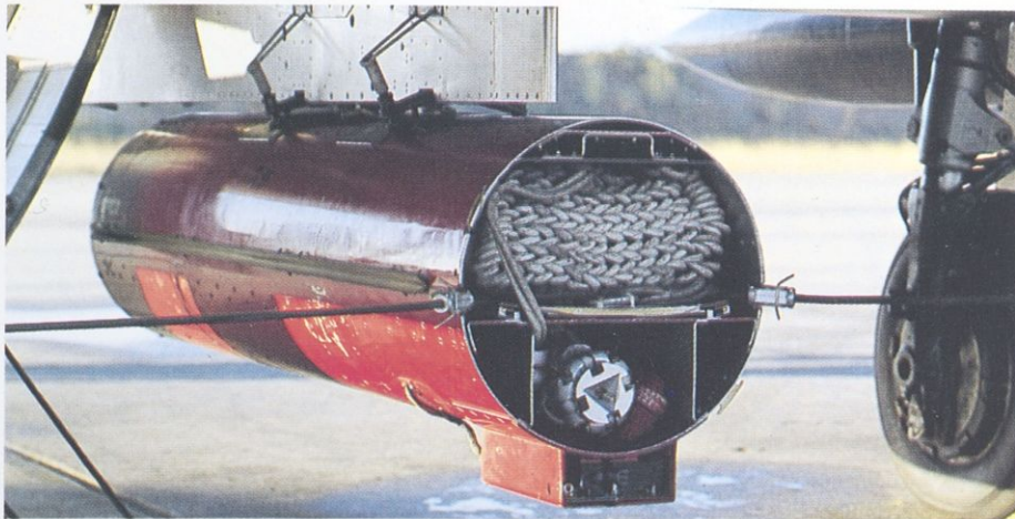
Une cible TAC 100 sous un Mirage VF avant le départ pour une mission de remorquage. Ce type de cible sert à l'entraînement au tir air/air des avions de combat de l'Armée de l'air.
