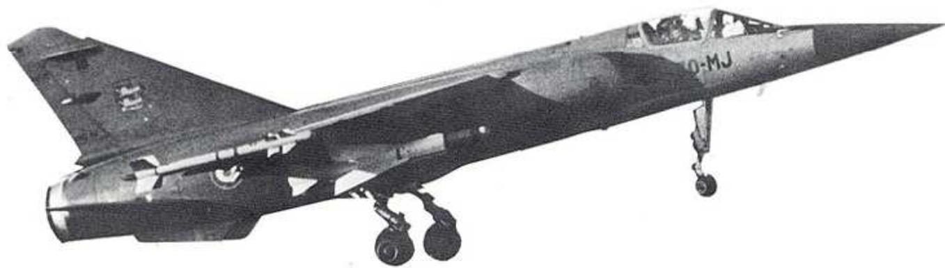
Le Mirage F.1C 30-MJ/10 atterrit à Reims, venant de Mont-de-Marsan en décembre 1975 avec le sergent Pomian aux commandes. C'était la seconde fois qu'un F.1C du Normandie-Niemen volait avec la charge offensive maximale : 2 Matra 530 sous voilure et 2 Matra 550 Magic en bouts d'ailes.
