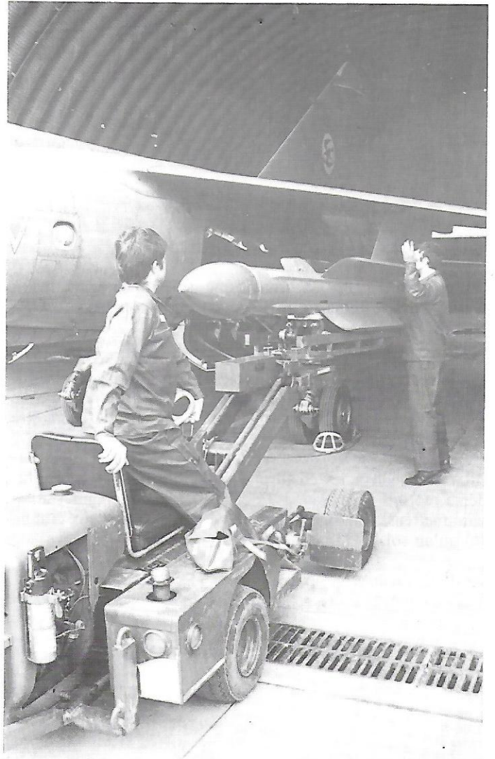
Montage d'un Super 530
